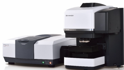
图 1 傅里叶变换红外分光光度计 IRTracerTM-100 (左) 和红外显微镜 AIM-9000 (右)
