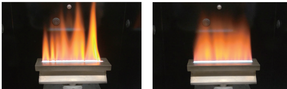
图4 60个样品连续测定后火焰的状态（左：连续法；右：一滴法）
