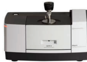
图 3 安装有 ATR 测定装置 QATR-S 的 IRSpirit
