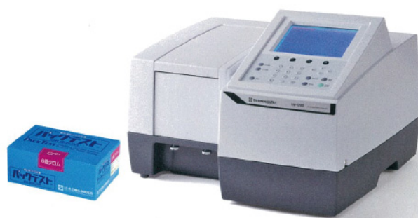
图 1 UV-1280 以及测试包的外观图 UV-1280 and PACKTEST
