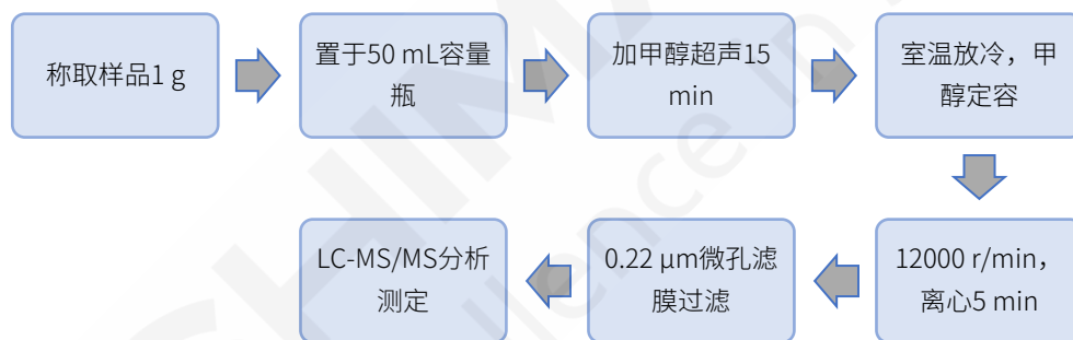
图1. 样品前处理流程图
