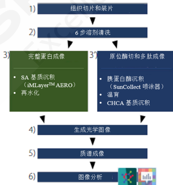
图 1. 蛋白和多肽质谱成像的工作流程 (SA 基质和 CHCA 基质)
