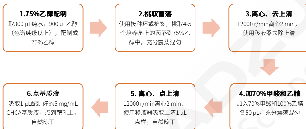
图 3. 乙醇甲酸提取法流程图
