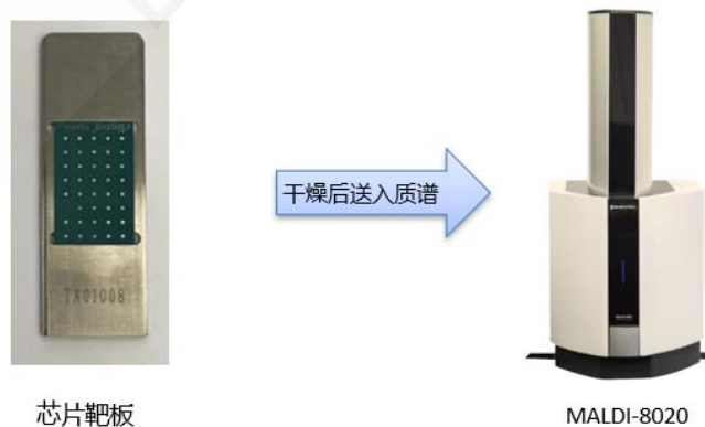
图 1. 核酸用芯片靶板及 MALDI-8020
