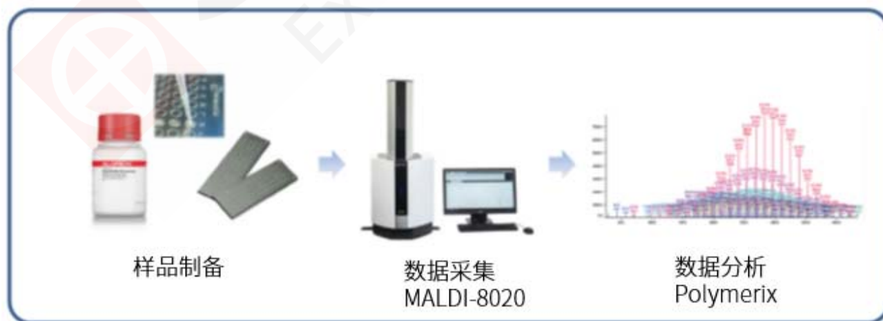
图2 维生素E-TPGS聚合物分析的工作流程
