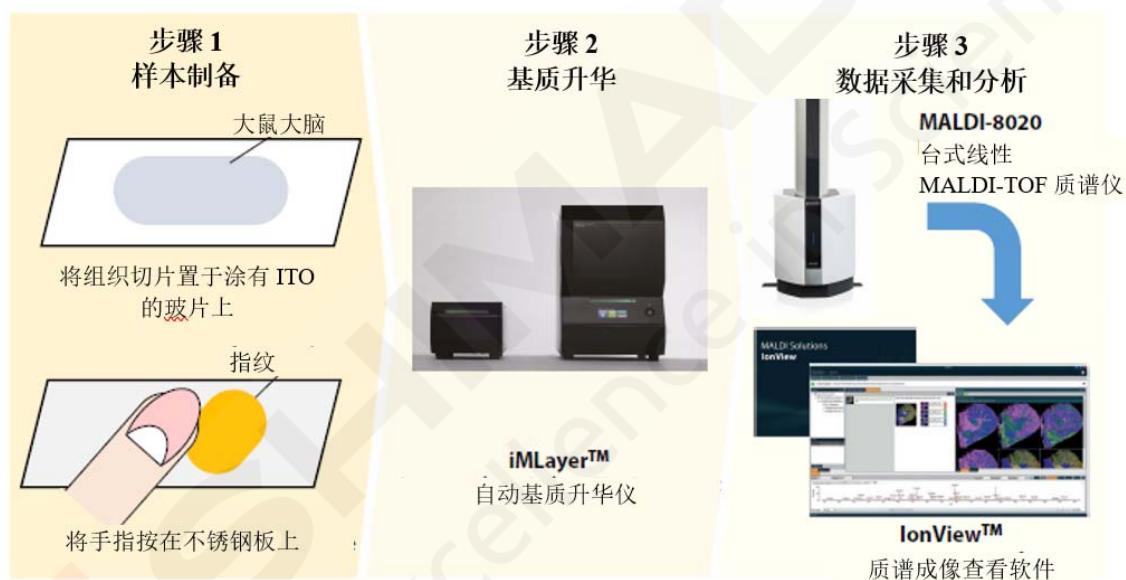
图 1. 使用 MALDI-8020 的质谱成像工作流程
