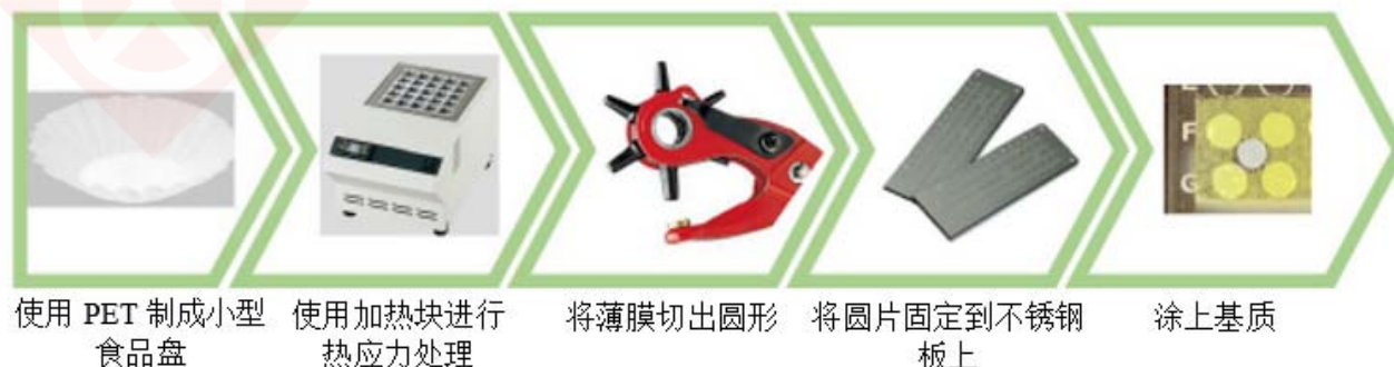
图3. 不同热应力条件下PET薄膜制备
