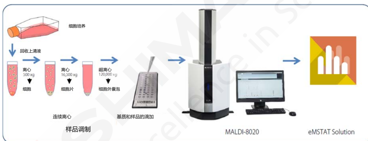
图1 细胞外囊泡的分析流程
