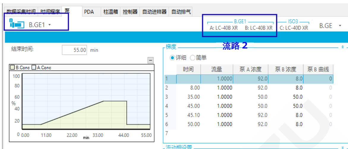
图 3 双进样液相色谱的梯度设置界面
