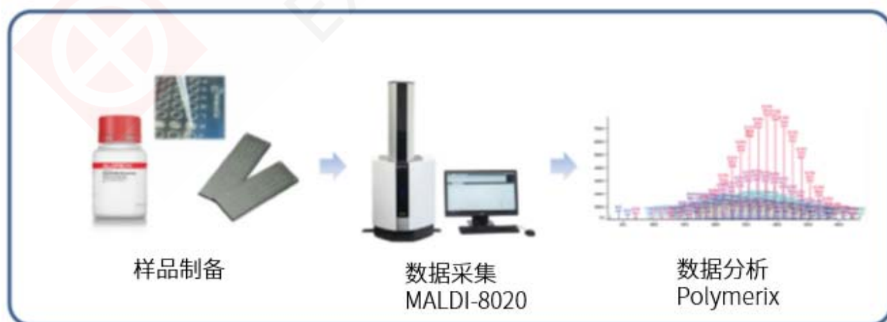
图2 维生素E-TPGS聚合物分析的工作流程
