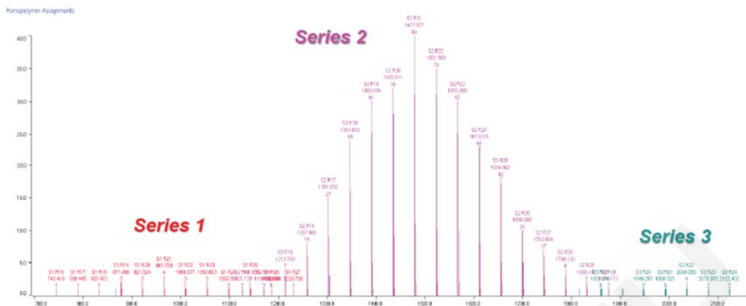
图7 使用Polymerix软件分析生成的均聚物的赋值图
