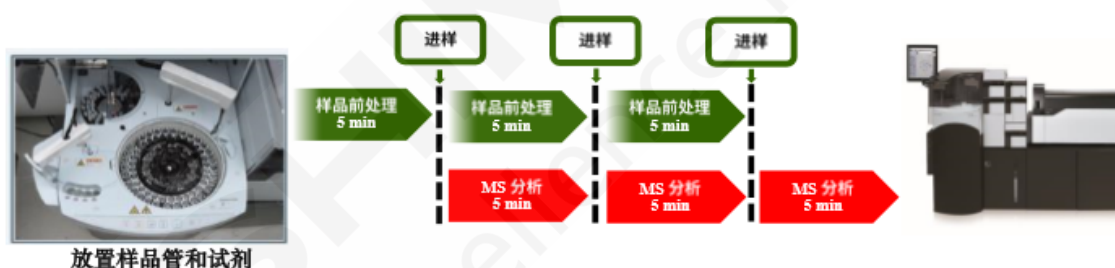
图 2. CLAM-2030 与 LC-MS/MS 联用工作模式
