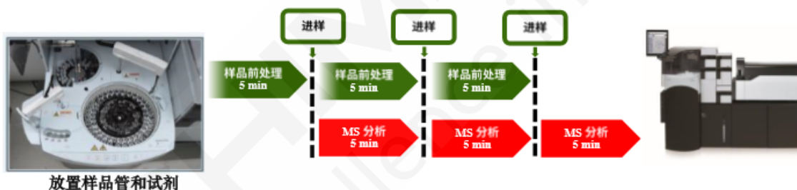
图 2. CLAM-2030 与 LC-MS/MS 联用工作模式
