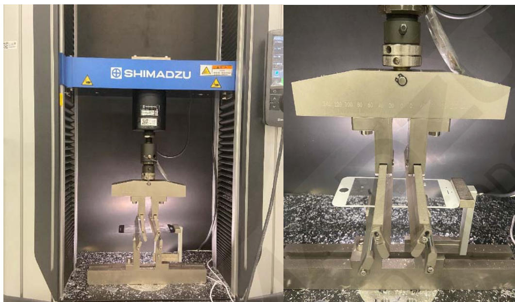
图 2.使用玻璃四点弯曲夹具进行试验
