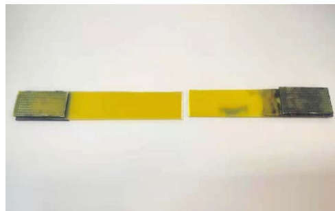
图 5. 试验断裂后图片
