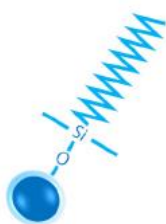
图2. Shim-pack Velox C18固定相示意图
