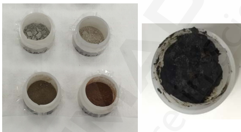
图 2 样品测试状态，105°C干燥后(左)，未经处理的原样(右)
