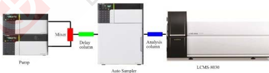
图 1 杂质延迟法液相系统连接示意图
