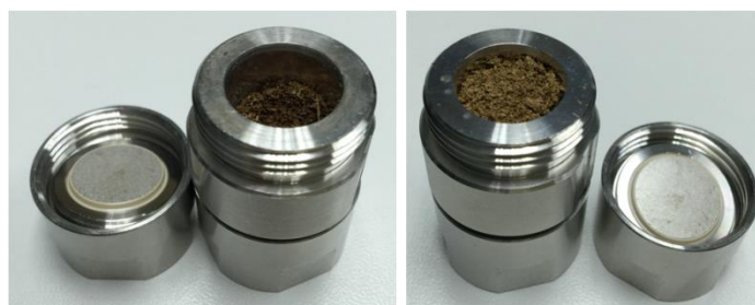
图 7. 1.00 g 和 2.00 g 样品装填在萃取罐中
