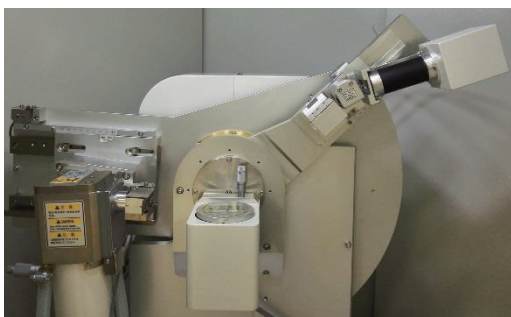
图3 掠入射非对称衍射几何实物图
