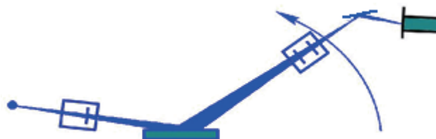
图 1 掠入射衍射光路——非对称衍射几何
