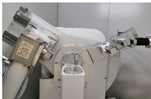
图4 常规 B-B 对称衍射几何实物图
