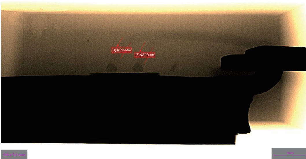
图 8 碳化硅 MOSFET 铝线尺寸测量图
