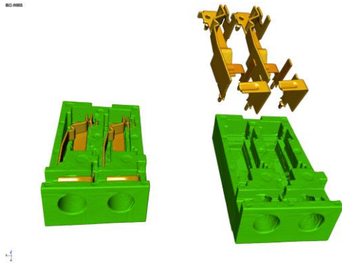
图 4 开关电器 3D 图（塑料和金属分开）
