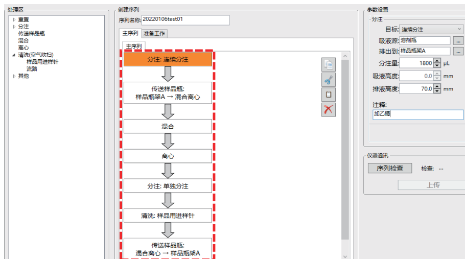
图 2 ATLAS-LEXT NHD 样品前处理软件界面及处理流程设置
