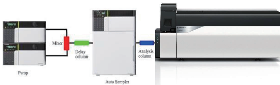
图 1 采用延迟法液相系统连接示意图
