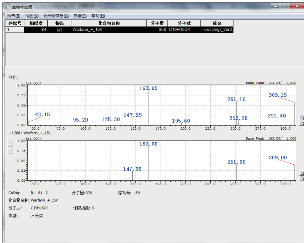
图10 Warfarin二级质谱图(上)与库中二级质谱图(下)匹配情况
