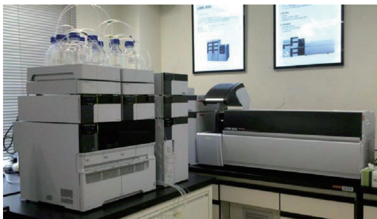
图1 方法开发系统与LCMS-8040联用
