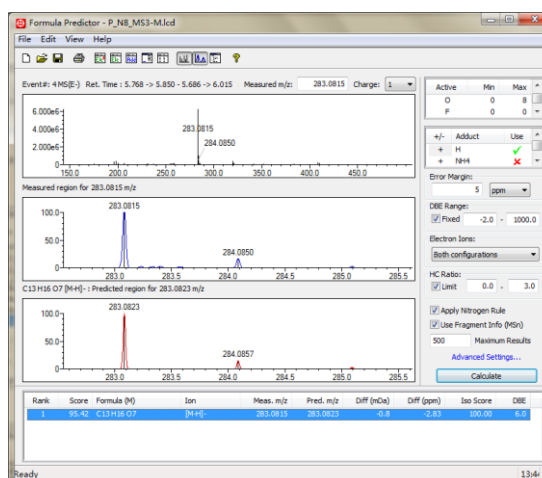
图 9 P1(m/z m/z 283.08) 多级质谱图的预测结果
