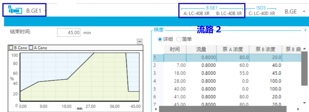
图 4 双进样液相色谱的梯度设置界面（流路 2）
