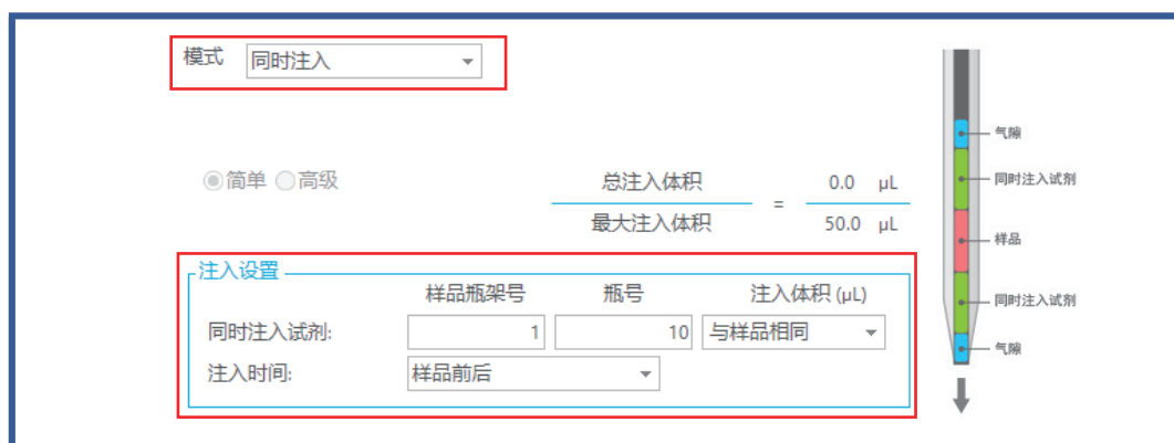
图 8 工作站实时分析窗口“自动进样器”项下的“同时注入”功能设置
