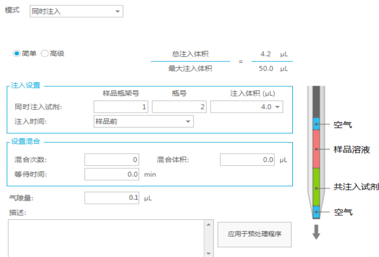
图 2. 自动进样器 SIL-40CXR 同时注入功能 (Co-injection) 程序设定
