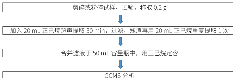
图 1 邻苯二甲酸酯含量测定前处理流程图
