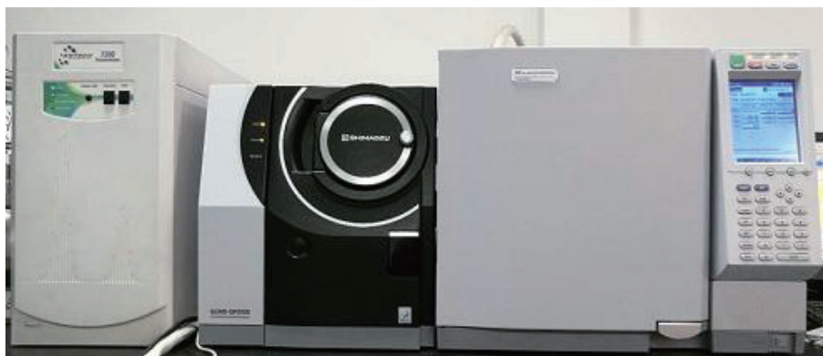
图 1 ENTECH 7200+ 岛津 GCMS 离线监测系统
