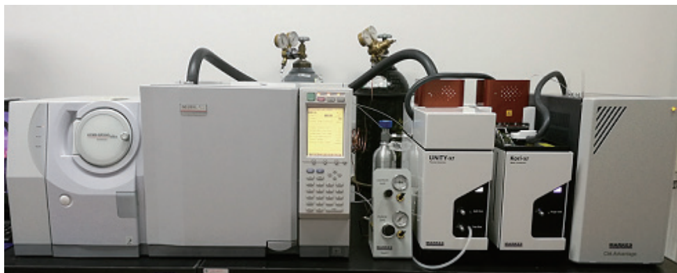
图 1 MARKES UNITY-xr+ 岛津 GC-FID-MS 离线检测系统
