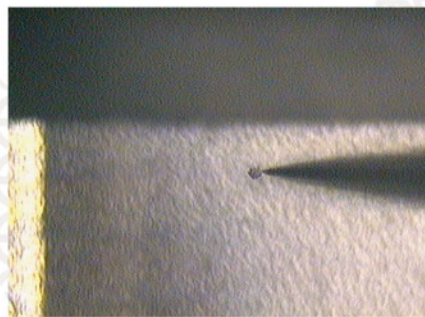
图2 使用金属针取出异物
