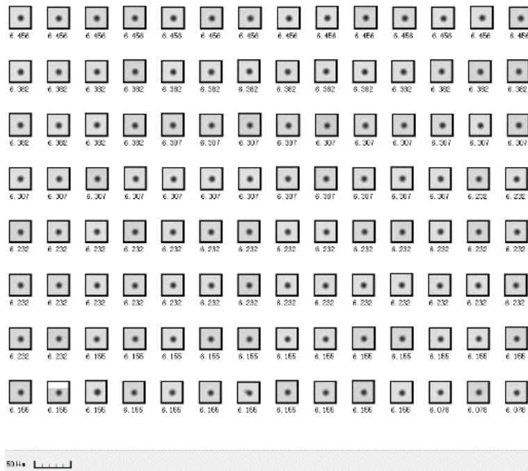
图9 预灌封注射器储存干扰素样品中不溶性微粒粒形图
