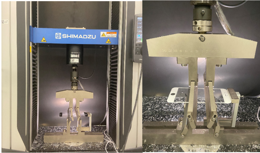
图 2 使用玻璃四点弯曲夹具进行试验
