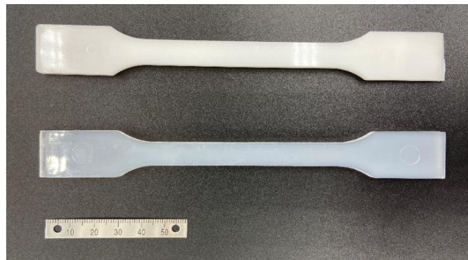
图 2 2 种塑料拉伸标准哑铃型试样
