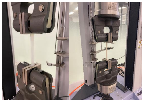
图 3 拉伸蠕变测试进行中
